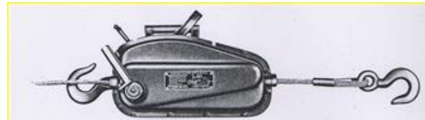
Tirfor, attrezzo impiegato per direzionare la caduta delle piante durante l'abbattimento.
